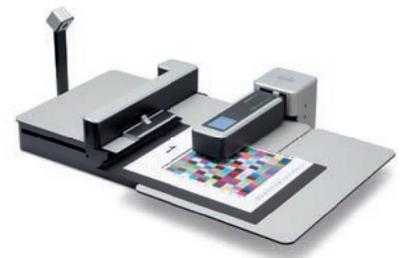
Le Spectro LFP qb permet des mesures de réflexion et de transmission entièrement automatisées pour matériaux jusqu'à 20 mm grâce à son ouverture de mesure variable de 2, 6 et 8 mm. Il est conçu pour mesurer tous les supports et matériaux dans diverses applications d'impression numérique.
