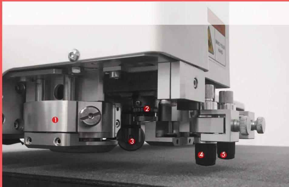
1 - Coupe oscillante : Disponible uniquement pour le modèle Plus, elle permet de couper des épaisseurs jusqu'à 6 mm selon le type de matériau.
