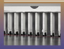
La table est protégée des frottements de la butée arrière par des racleurs en plastique montés sur ressort.
