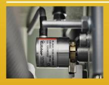
L'encodeur rotatif est monté directement sur la vis sans fin pour un positionnement de haute précision
