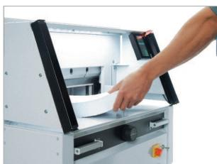
Barrage immatériel par cellules photo-électriques.
