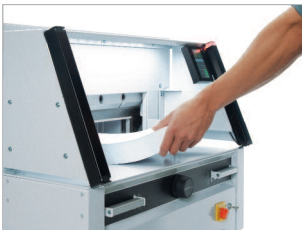
Barrage immatériel par cellules photo-électriques.
