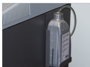
Lubrification automatique des cylindres de coupe.
