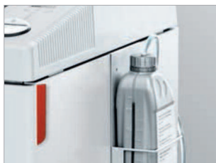
Lubrification automatique des cylindres de coupe.
