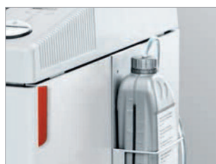
Lubrification automatique des cylindres de coupe.
